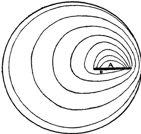
FIG. 4.—ISOTHERMS AROUND RADIOMETER VANE IN SPHERICAL GLASS BULB—MEDIUM GAS PRESSURE.\*
