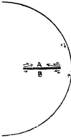
FIG. 5.—FLOW AROUND RADIOMETER VANE IN SPHERICAL GLASS BULB.
