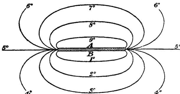
FIG. 1.—ISOTHERMS AROUND RADIOMETER VANE—PRESSURE HIGH.
