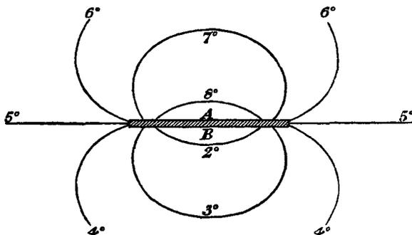
FIG. 2.—ISOTHERMS AROUND RADIOMETER VANE—PRESSURE LOW.
